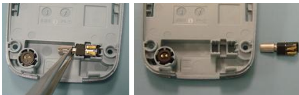
Remove Vibramotor
